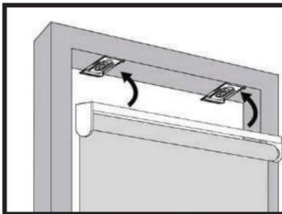
2. Accrochez le rail au bas du support et faites-le pivoter jusqu'à ce que l'arrière du rail s'enclenche solidement en place.
