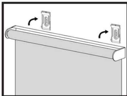
2. Accrochez le rail à l'avant du support et faites-le pivoter jusqu'à ce que l'arrière du rail s'enclenche solidement en place.
